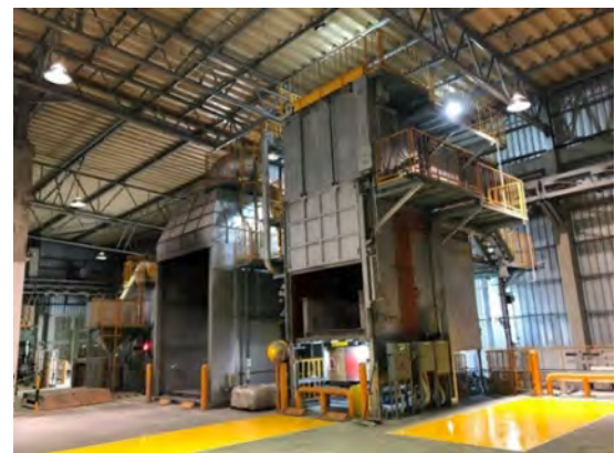
เครื่อง Metal Reclaiming Machine: MRM สำหรับนำอลูมิเนียมกลับมาใช้ใหม่
