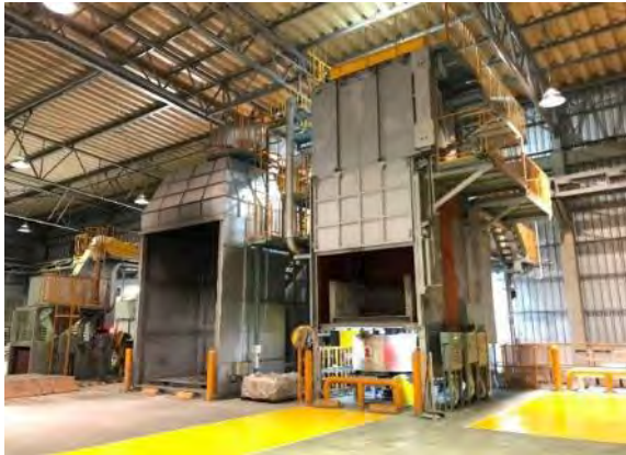
เครื่อง MRM สำหรับตีงอลูมิเนียมในขั้นตอนอลูมิเนียม DROSS กลับไปหลอมใหม่
