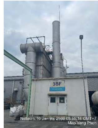
Bag Filter no.3 สำหรับนำอลูมิเนียมกลับมาใช้ใหม่
