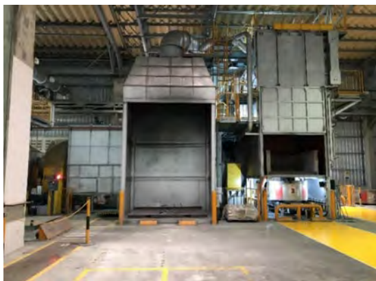
เครื่อง Metal Reclaiming Machine: MRM สำหรับนำอลูมิเนียมกลับมาใช้ใหม่
