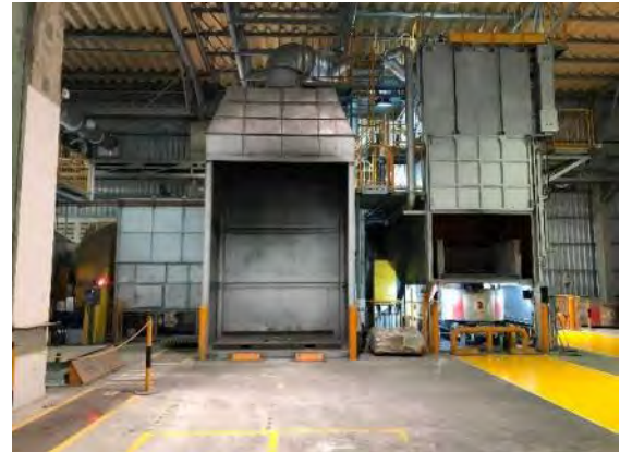
เครื่อง MRM สำหรับตีงอลูมิเนียมในขั้นตอนอลูมิเนียม DROSS กลับไปหลอมใหม่
