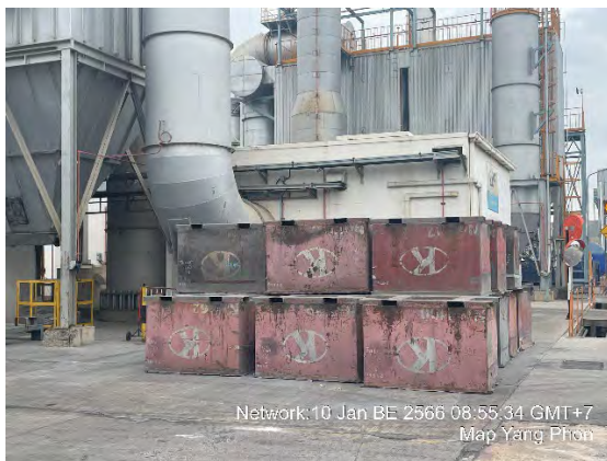
ภาชนะบรรจุ DROSS ASH หลังออกจากเครื่อง MRM
